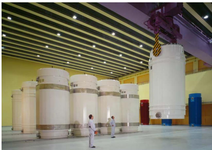
Conteneurs de combustible usé et de déchets de haute activité au Centre d'entreposage de Würenlingen, dans le canton d'Argovie. (Photo: Zwilag)
