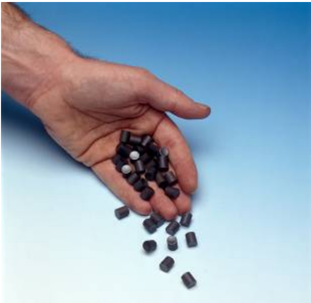
Le combustible d'uranium tel qu'il se présente pour son utilisation dans les centrales nucléaires. Deux de ces pastilles d'oxyde d'uranium ( UO_2 ) permettent de couvrir la consommation d'électricité d'un ménage de quatre personnes pendant un an. (Photo: Centrale nucléaire de Gösgen)
