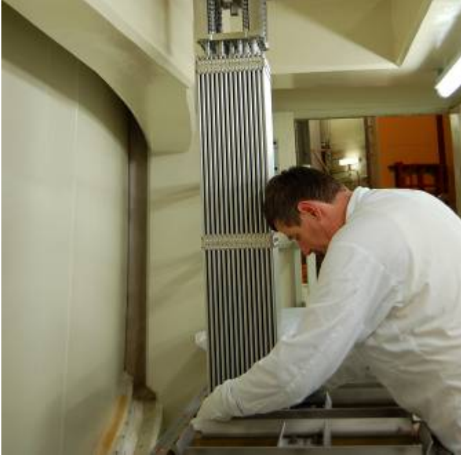
Un assemblage combustible est préparé pour son chargement dans le réacteur: le génie nucléaire est propre, compact et n'exige pas de transports massifs de matériel, contrairement au charbon, au pétrole ou au gaz naturel. (Photo: Centrale nucléaire de Gösgen)
