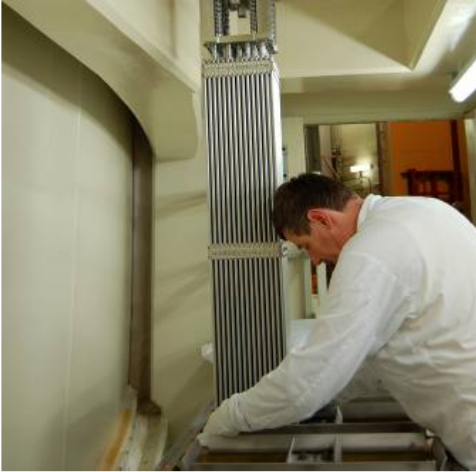
Ein Brennelement wird für den Einsatz im Reaktor vorbereitet: Die Kernenergietechnik ist sauber, kompakt und benötigt keine riesigen Materialtransporte wie Kohle, Erdöl oder Erdgas. (Bild: KKG)
