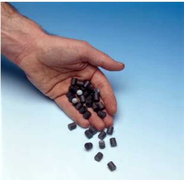
Der Kernbrennstoff Uran in der Form, wie er in den Kernkraftwerken zum Einsatz kommt. Aus zwei solchen Uranoxid-Tabletten ( UO_2 ) lässt sich soviel Strom erzeugen, wie ein 4-Personen-Haushalt in einem Jahr verbraucht. (Bild: KKG)
