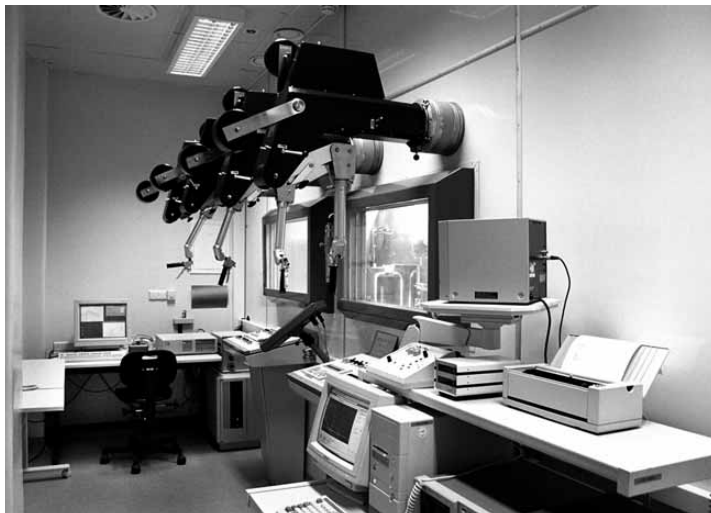
L'analyse de matériaux irradiés nécessite des cellules dites chaudes telles que celles dont dispose le FZD.
