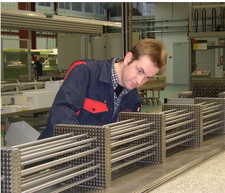
Ein besonderes Material mit einer enormen Energiereserve für die Zukunft: Montage eines Brennelements mit Uran für den Einsatz in einem herkömmlichen Leichtwasserreaktor.
