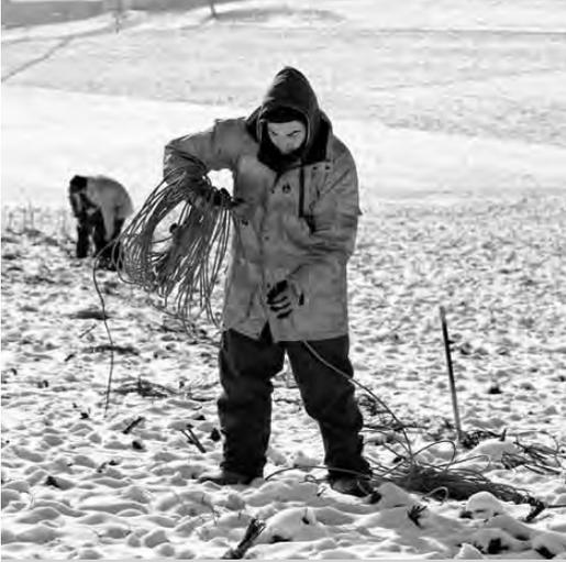
Um ein Gebiet seismisch zu untersuchen, legen Geologen Messkabel mit Geofonen entlang der Messlinie aus.
