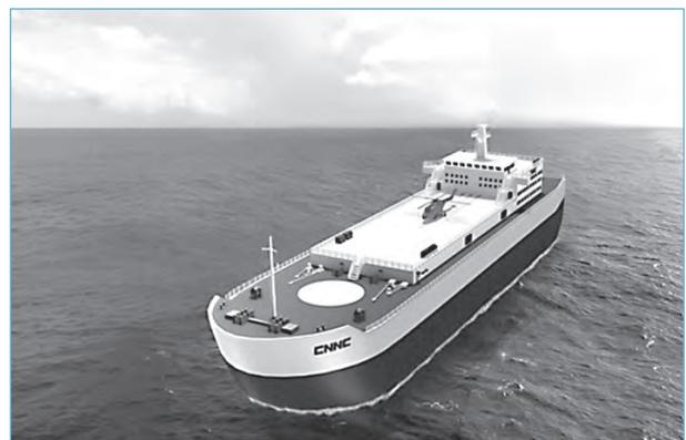
Modellzeichnung des geplanten schwimmenden Kernkraftwerks der CNNC.
