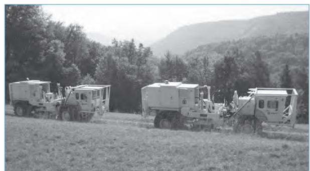
Vibrationsfahrzeuge im Feld erzeugen die für die Messungen nötigen Schwingungen.
