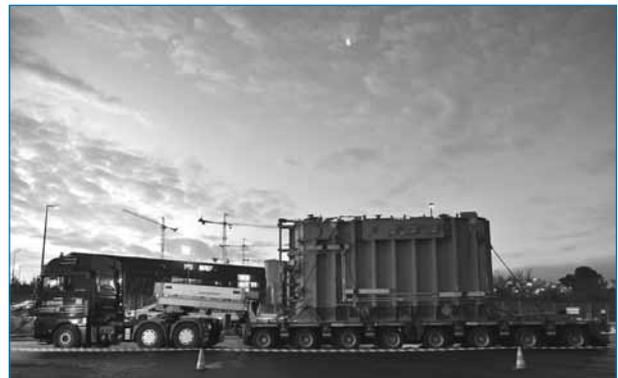
Der Transformator – eine von vier identischen Komponenten – verbindet die elektrische Verteilanlage des Iter mit dem 400-kV-Unterwerk.
