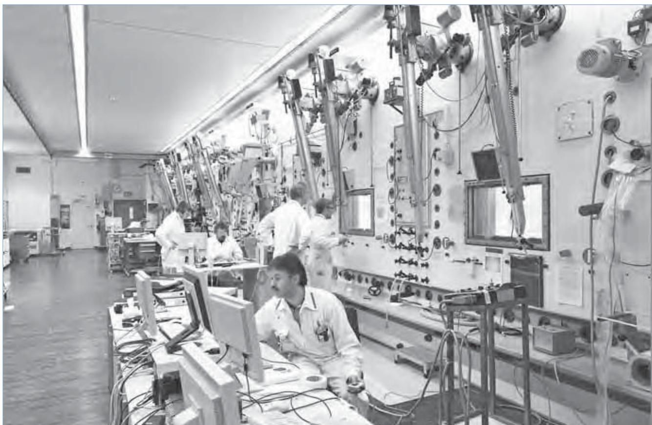
**Im Hotlabor des PSI: Die Hotzellenkette dient zur Untersuchung von Kernbrennstäben und zur mechanischen Werkstoffbearbeitung und -prüfung. Die Arbeiten hinter 1 m dicken Betonmauern erfolgen mittels Manipulatoren.**
