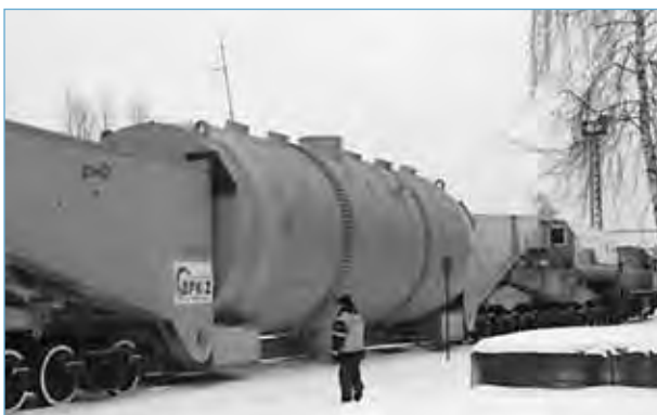
Ein Dampferzeuger wird auf einem 66 m langen Gelenkzug zum Standort Nowoworonesch transportiert.
