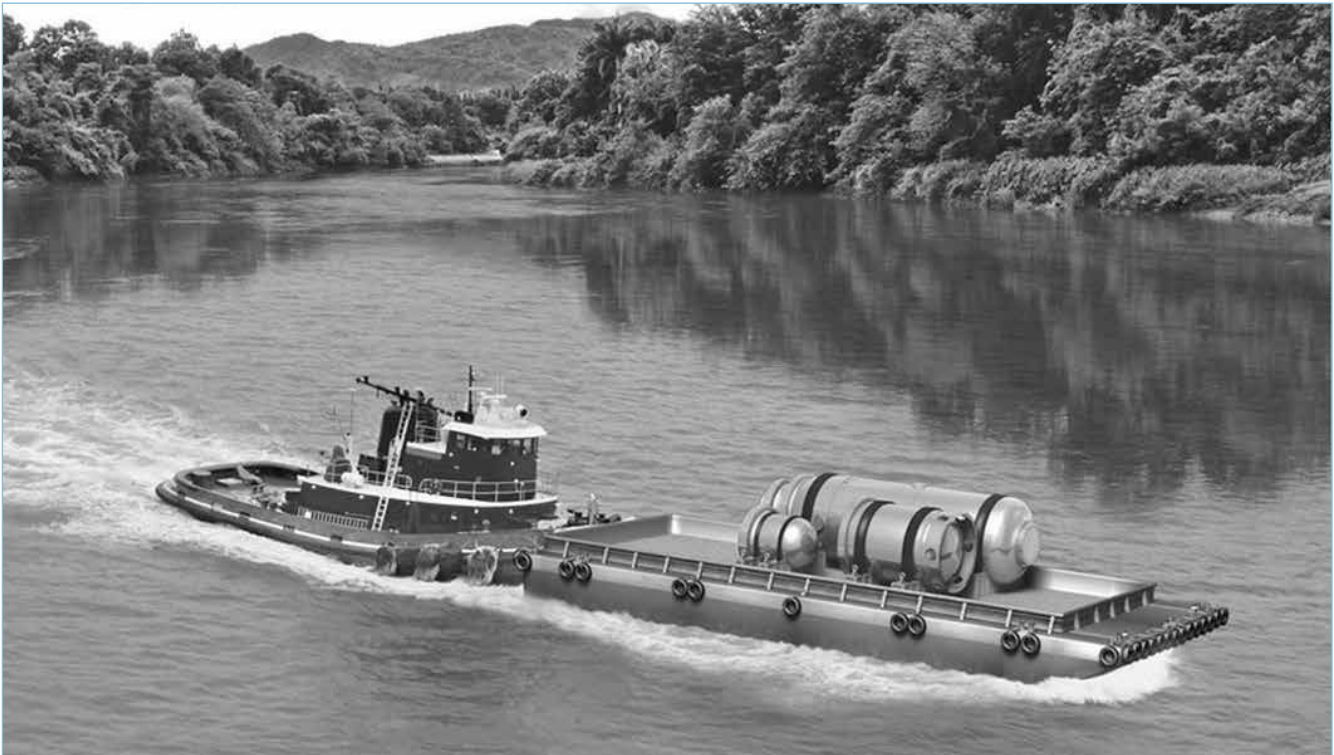
NuScale-SMR-Module können auch per Schiff an entlegene Standorte transportiert werden.
