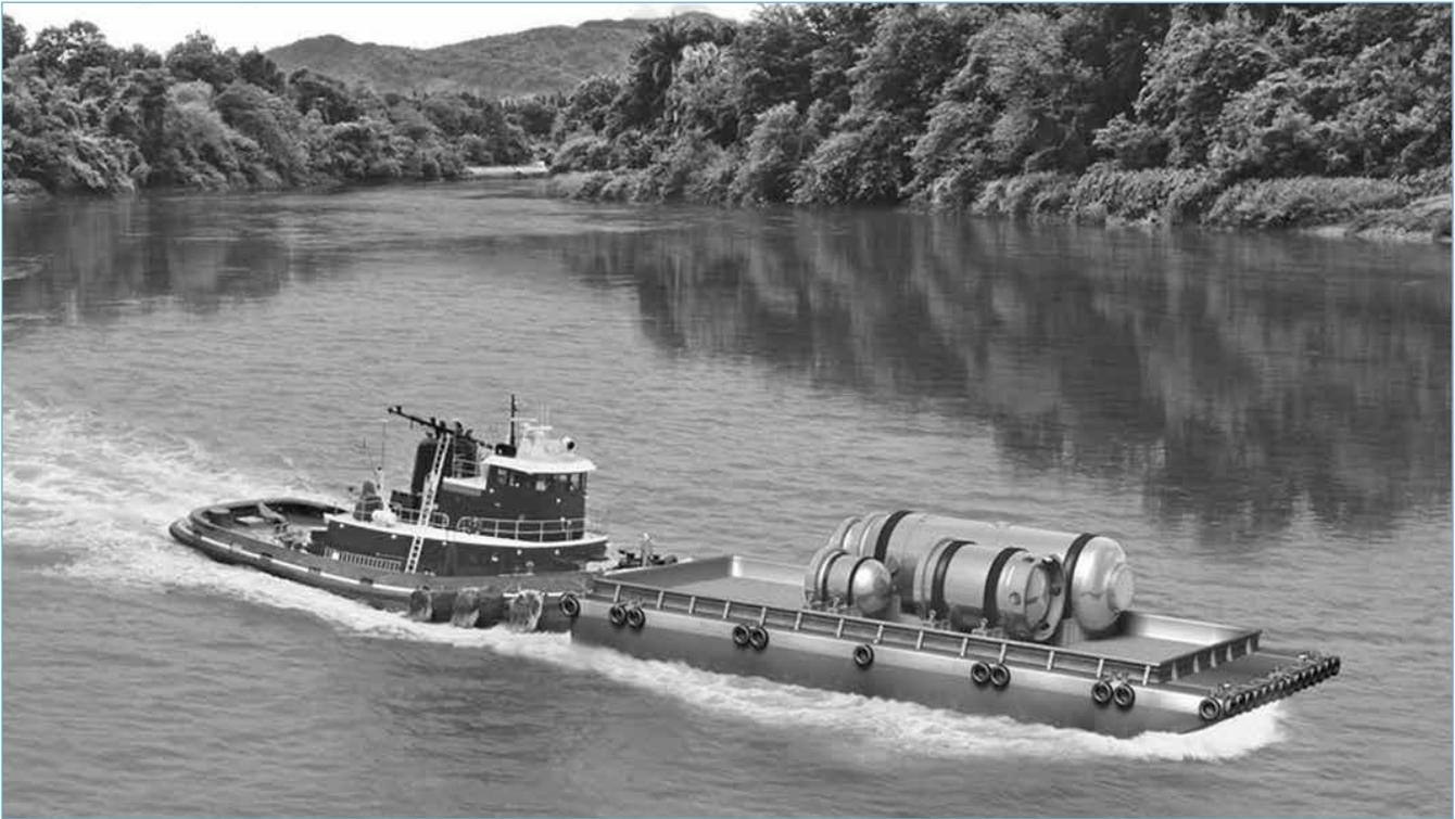
**Les modules du SMR développé par NuScale peuvent également être transportés par bateau sur des sites reculés.**
