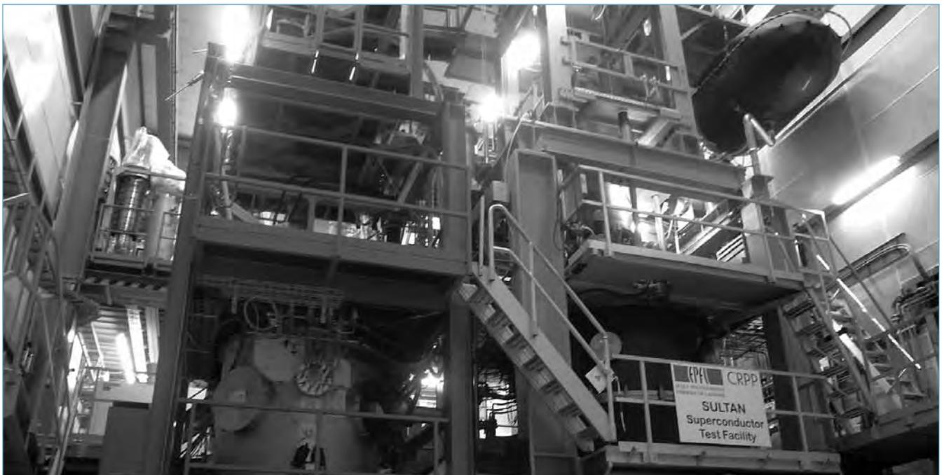
l'Iter. Pour ce faire, les échantillons sont refroidis avec de l'hélium supercritique jusqu'à atteindre 4,5 K et sont traversés par un courant d'une intensité maximale de 68 kiloampères (kA) (courant continu). Sultan génère un champ de fond homogène de 11 teslas (T) sur une longueur de 450 mm environ, et simule ainsi le champ maximal d'Iter. Sultan a fait l'objet d'un seul rééquipement depuis sa mise en service. La configuration actuelle existe depuis plus de 20 ans.
