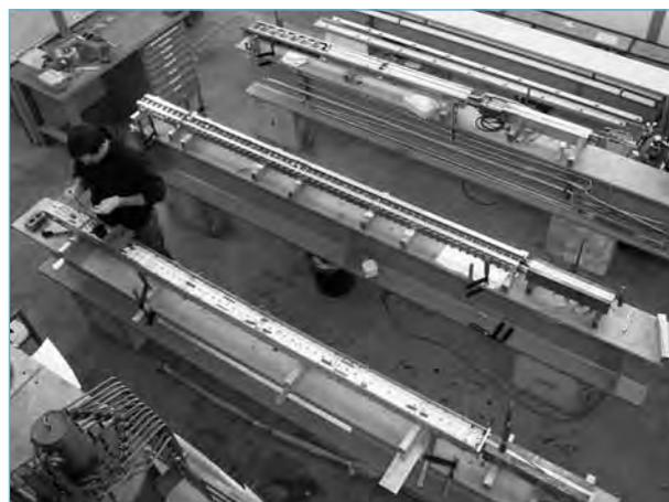
**Un spécialiste du PSI, à Villigen, prépare l'échantillon d'un câble supraconducteur destiné au test. Des contacts électriques sont placés sur le côté droit de l'échantillon. Ils sont reliés aux extrémités d'un câble placé à l'intérieur de rails de guidage, qui est déplacé en un mouvement de va-et-vient par les contacts.**
