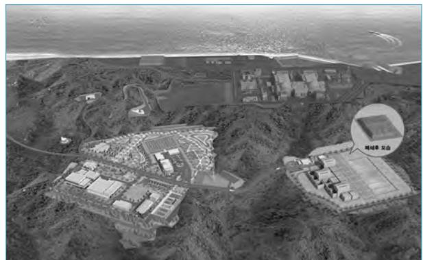
**Phase 1 – ein Tiefenlager für schwach- und mittelaktive Abfälle (links) – und Phase 2 – ein oberflächennahes Lager (rechts) – des Entsorgungszentrums im südkoreanischen Gyeongju in der Nähe des Kernkraftwerks Wolsong.**
