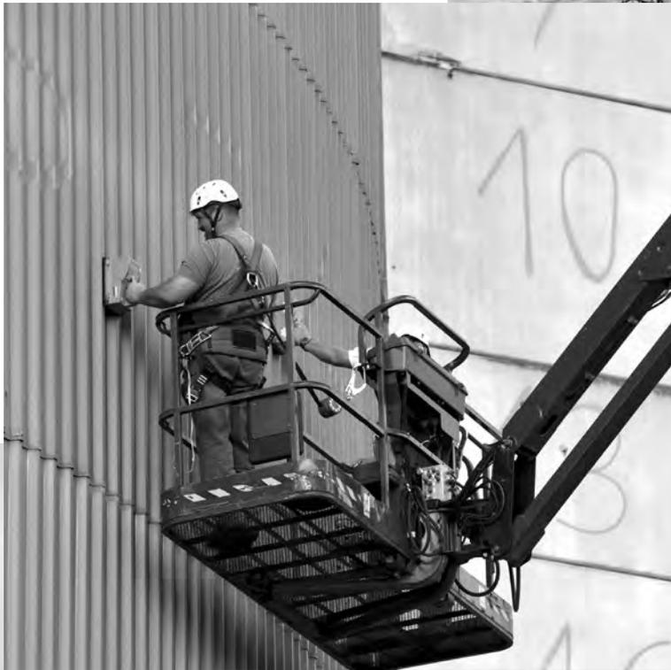
**◀ Strahlungsmessungen an der Aussenhülle des Reaktorgebäudes.**
