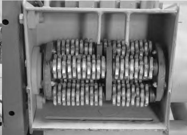
◀ Auf Kletter-Roboter montierte Fräse zum Abtragen kontaminierter Oberflächen.
