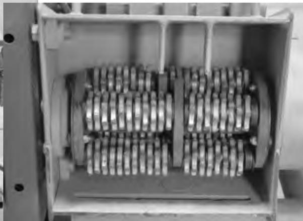
◀ **Fraise montée sur un robot grimpeur pour l'abrasion de surfaces contaminées.**
