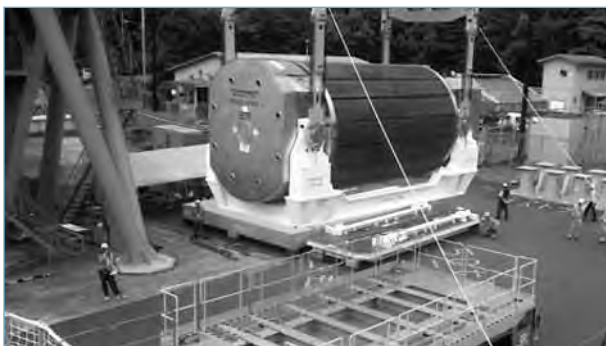
Un conteneur d'éléments combustibles d'Areva est déchargé dans le port de Takahama, au Japon, avant de poursuivre sa route.
