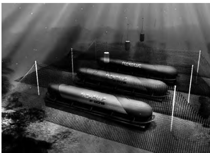
Croquis d'étude de la centrale nucléaire modulaire sous-marine Flexblue.
