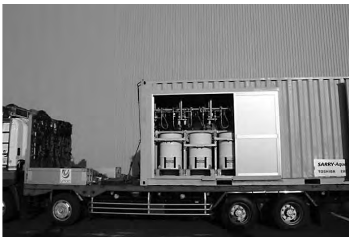
De l'eau contaminée rendue potable grâce au système Sarry-Aqua.
