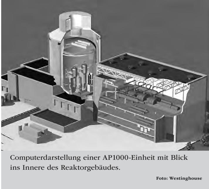
Computerdarstellung einer AP1000-Einheit mit Blick ins Innere des Reaktorgebäudes.
