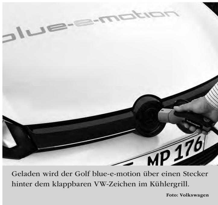
Geladen wird der Golf blue-e-motion über einen Stecker hinter dem klappbaren VW-Zeichen im Kühlergrill.
