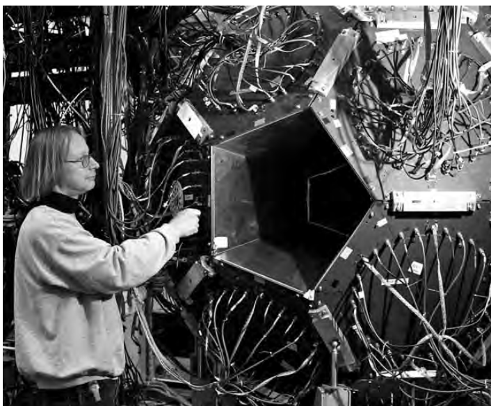
Bernhard Lauss, chercheur au PSI, devant le détecteur destiné à mesurer la durée de vie du muon.
