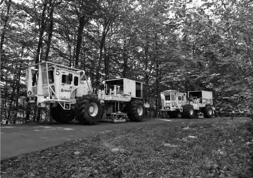
Seismische Messungen der Nagra: Mit den Vibrationsfahrzeugen werden rund 260 km Messlinien entlang von 14 Profilen aufgenommen.
