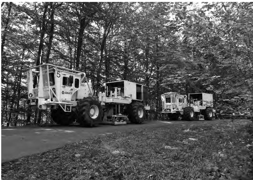
Mesures sismiques de la Nagra: les véhicules de mesure vibratoire enregistreront quelque 260 km de lignes de mesures le long de 14 profils.
