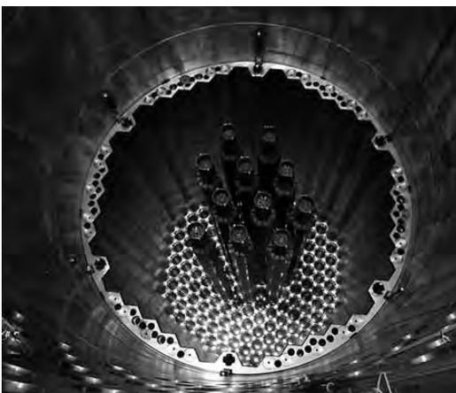
Blick in den Reaktorkern der vierten Einheit des Kernkraftwerks Kalinin.
