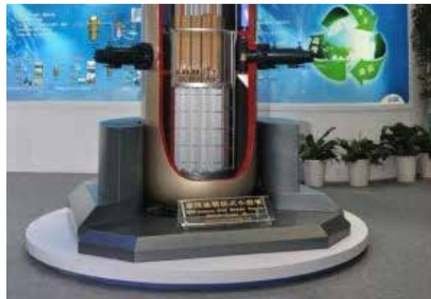
Der chinesische ACP100 (Advanced Chinese Pressurized Water Reactor) stammt von der französischen Druckwasserreaktorlinie ab. Alle primären Systeme wie Druckhalter und Dampferzeuger sind im Reaktordruckbehälter integriert. Das passive Kühlsystem ist vom AP1000 von Westinghouse und dem fortgeschrittenen chinesischen Hualong One übernommen worden. Die Reaktorauslegung des ACP100 ist 2016 von der IAEO erfolgreich geprüft worden.
