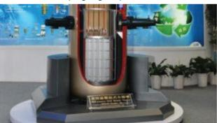
Le type chinois ACP100 (Advanced Chinese Pressurized Water Reactor) est fondé sur la série des réacteurs à eau sous pression française. Tous les systèmes primaires tels que le pressuriseur et le générateur de vapeur sont intégrés dans la cuve de pression. Le système de refroidissement passif a été repris de l'AP1000 de Westinghouse et du type chinois avancé Hualong One. L'AIEA a étudié la conception de l'ACP100 et remis un avis favorable en 2016.
