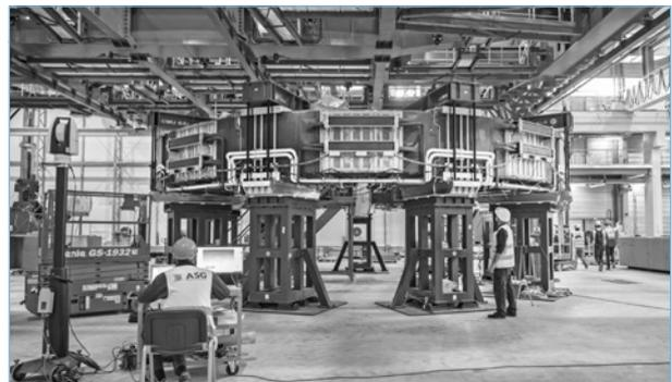
La bobine de champ poloïdal n° 6, fabriquée en Chine, est testée dans l'installation de bobinage de Cadarache.
