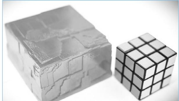
**Ce cristal d'un poids de 3,8 kg et de formule  $\text{CH}_3\text{NH}_3\text{PbBr}_3$  est capable de détecter le rayonnement gamma. Le Rubik's Cube permet de se faire une idée de sa taille.**
