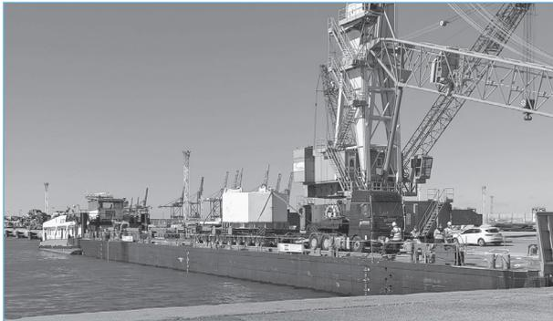
**Das 110 t schwere Modul ist eines der drei «unteren Module» des aus sechs Modulen bestehenden zentralen Solenoids. Das Bild zeigt, wie es an Bord eines speziell konstruierten Lastkahns das Binnenmeer Étang de Berre überquert.**
