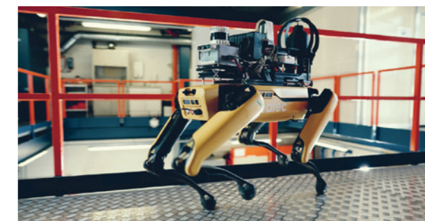
Des techniques dernier cri au service de la radioprotection: le robot Spot se rend dans les zones présentant un débit de dose élevé. (Photo: Axpo)
