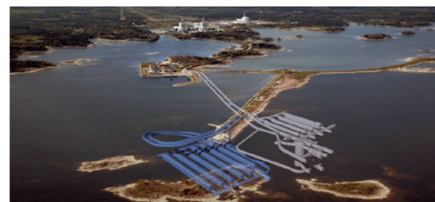
L'extension en projet (en bleu) du SFR comprend six nouvelles cavernes. (Photo: SKB)
