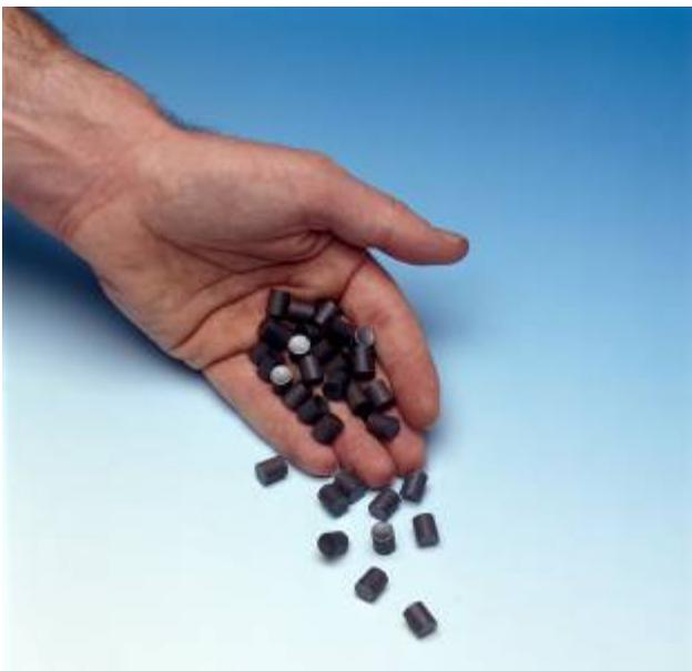
*Der Kernbrennstoff Uran in der Form, wie er in den Kernkraftwerken zum Einsatz kommt. Aus zwei solchen Uranoxid-Tabletten ( $UO_2$ ) lässt sich soviel Strom erzeugen, wie ein 4-Personen-Haushalt in einem Jahr verbraucht. (Bild: KKG)*
