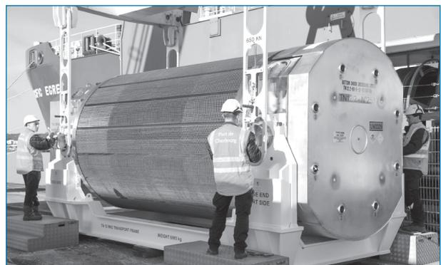
**Ein Behälter mit Mox-Brennelementen wird auf das Schiff Pacific Egret geladen.**
