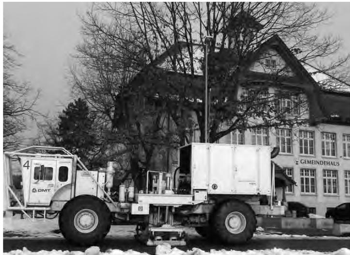
Mini-séismes au service de la science: véhicules vibrants en action à Unterentfelden (AG).
