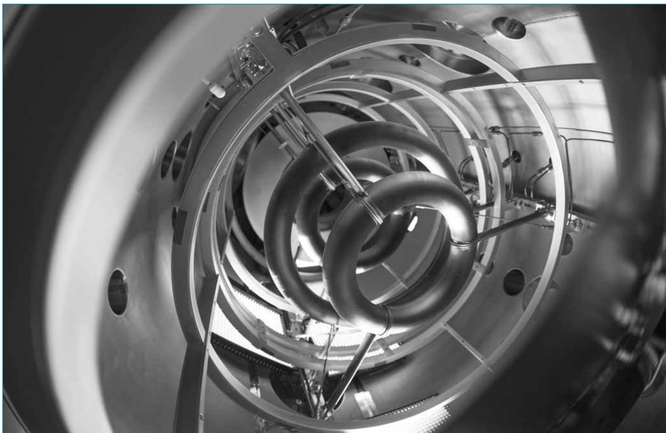
Blick ins Innere des CFR: Die magnetischen Spulen in der Plasmakammer des kompakten Fusionsexperiments von Lockheed Martin.
