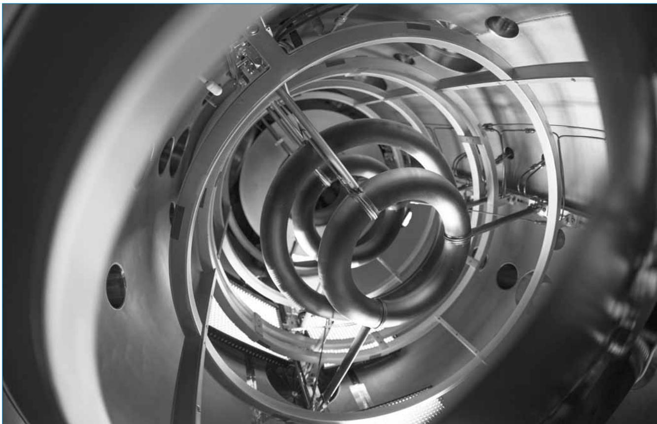
**Coup d'œil à l'intérieur du CFR: bobines magnétiques situées à l'intérieur de la chambre du plasma du réacteur de fusion compact développé par Lockheed Martin.**
