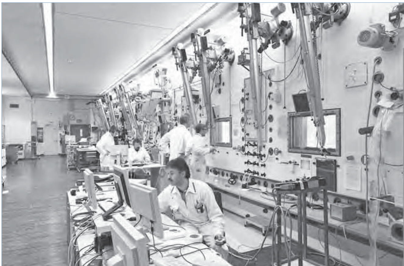
La ligne de cellules chaudes du laboratoire chaud du PSI sert à l'étude de crayons combustibles ainsi qu'au traitement mécanique et à l'analyse de matériaux. Les travaux sont effectués au moyen de systèmes de manipulation actionnés derrière des murs d'un mètre d'épaisseur.
