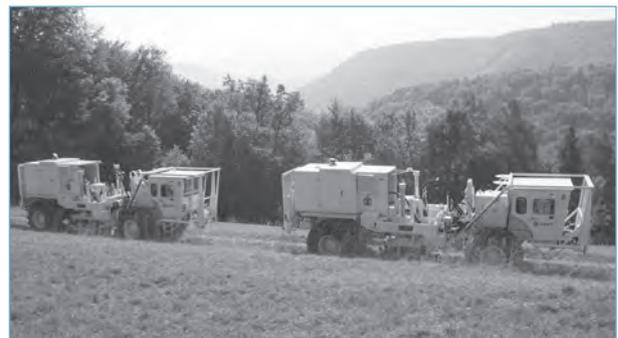
Des véhicules vibrateurs produisent les vibrations nécessaires aux mesures.
