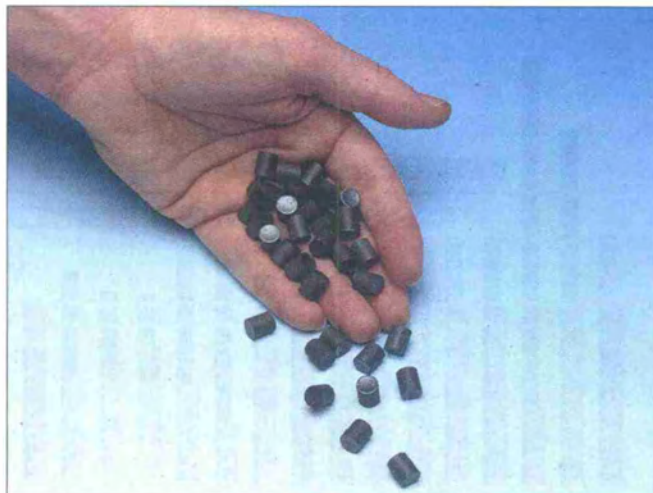
Mit einer Uranoxid-Tablette kann ein Zwei-Personen-Haushalt ein Jahr lang mit Strom versorgt werden. (Foto: Kernkraftwerk Gösgen)
