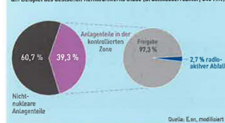
Anteil des radioaktiven Abfalls am rückgebauten Material am Beispiel des deutschen Kernkraftwerks Stade (Druckwasserreaktor, 640 MW)
